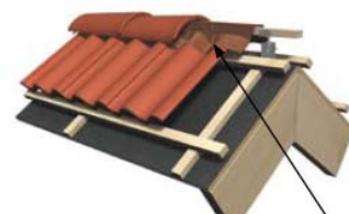
wykonanie taśmy zabezpieczającej kalenicę (Aerogratrolle)
